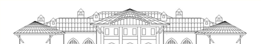
Şekil 11: Aynı Yapıdaki Farklı Çatı Gruplarında Kiremitlerin Yerleştirilmesi
